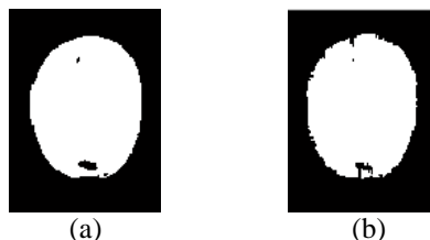
Gambar 10. Hasil Segmentasi Citra Tomat (a) Sebelum Dilakukan Perbaikan (b) Setelah Dilakukan Perbaikan
