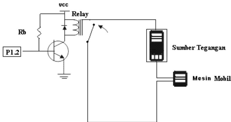
**Gambar** Antarmuka mikrokontroler dengan rangkaian mesin
