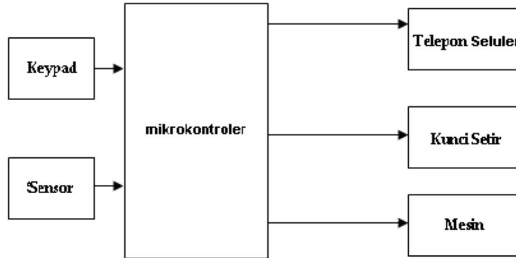
**Gambar** Blok diagram perancangan alat
